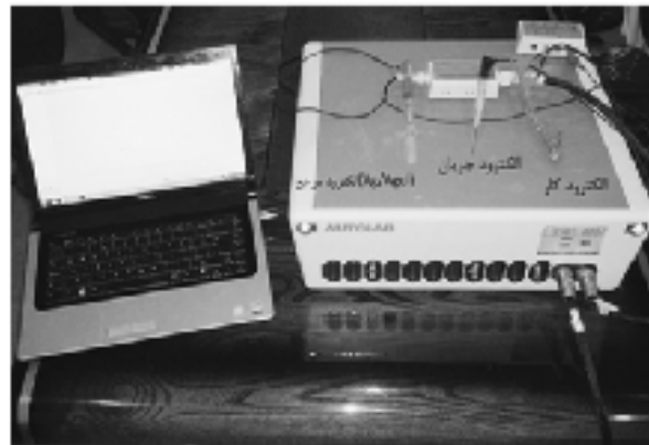
شکل ۲: دستگاه اندازه گیری سه الکتروود برای میلگرد در بتن.
