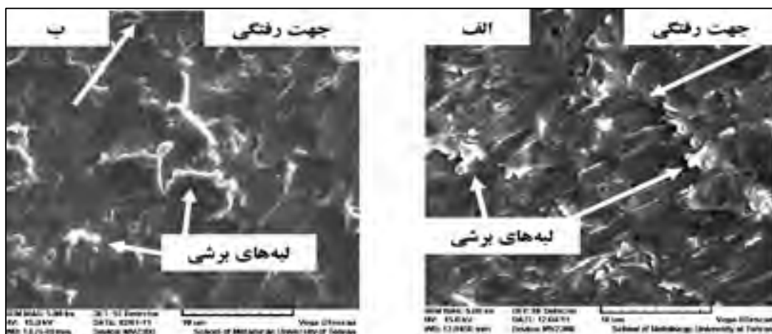
شکل ۴: تصاویر SEM سطوح رفتگی نمونه های فولادی در سرعت ۶/۵ m/s و زاویه برخورد ۵۰ درجه در غلظت های الف: ۳۰ g/l و ب: ۹۰ g/l ذرات ساینده.
