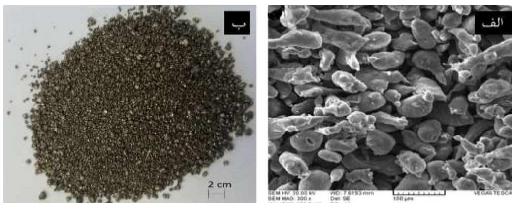
شکل ۱: (الف) تصویر میکروسکوپ الکترونی روبشی پودر آلومینیم خالص اولیه و (ب) تصویر مخلوط پودر آلومینیم و نانو ذرات زیرکونیوم اکسید پس از آسیاب کاری مکانیکی خشک.
