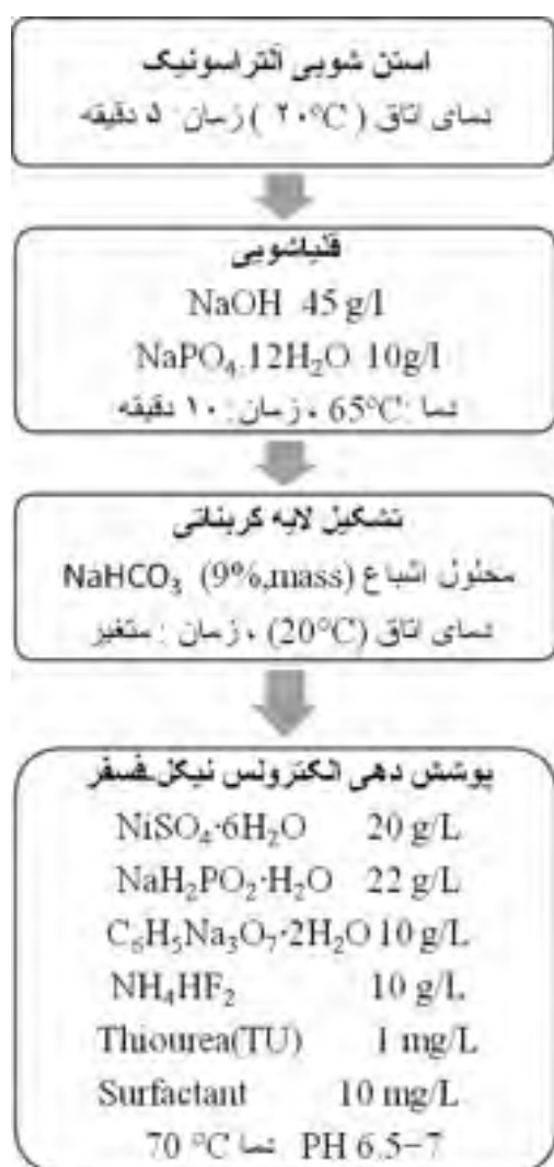
شکل ۱- فلوچارت مراحل پوشش دهی الکترولس Ni-P بر آلیاژ منیزیم AZ31
