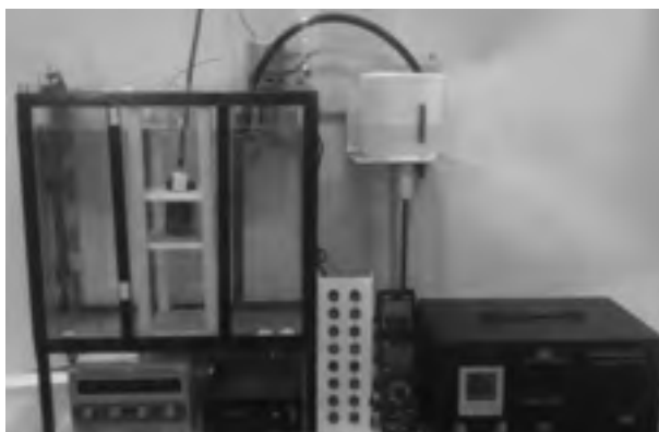
شکل ۱: مدل آزمایشگاهی جهت شبیه سازی تداخل جریان های سرگردان با سیستم های حفاظت کاتدی.
