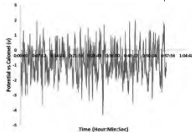
شکل ۳: نمودار تغییرات پتانسیل خط لوله گاز در نزدیکی ایستگاه تجریش در خط متروی تهران.
