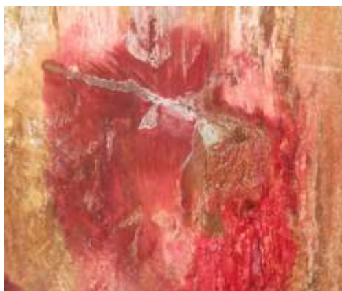
شکل ۳- ترک‌های بدنه پس از انجام آزمایش مواد نفوذ کننده - نمای نزدیک نفوذ کننده
