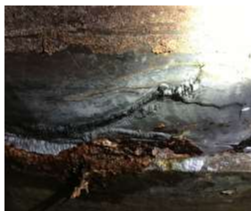
شکل ۴- ترک‌های بدنه پس از انجام آزمایش مواد نفوذ
