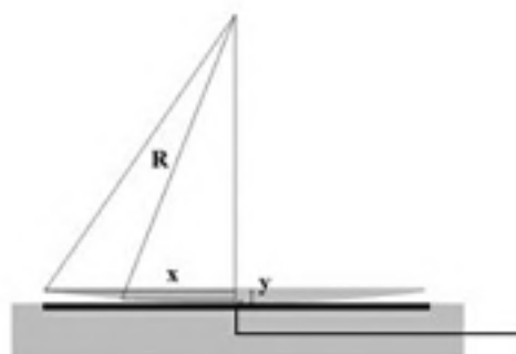
شکل ۱: طرحواره ای از نمونه الکتروشیمیایی مانت شده و عدسی که چگونگی محاسبه ارتفاع شکاف را نشان می دهد.
