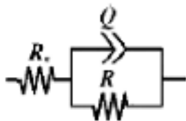
شکل ۱۱: مدار معادل نمودارهای نایکوئیست.
