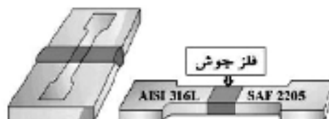
شکل ۲: شماتیک نمونه آزمایش کشش.
