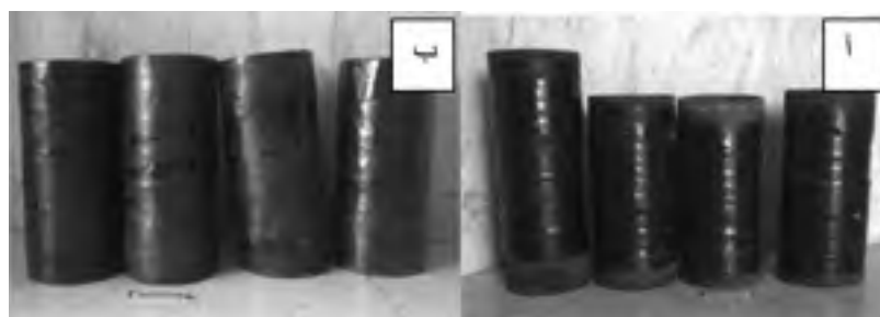
شکل ۳- نوارپیچی با نوارهای سرد اجرای نمونه ها (T)، نوارپیچی با نوارهای گرم اجرای نمونه ها (ب)
