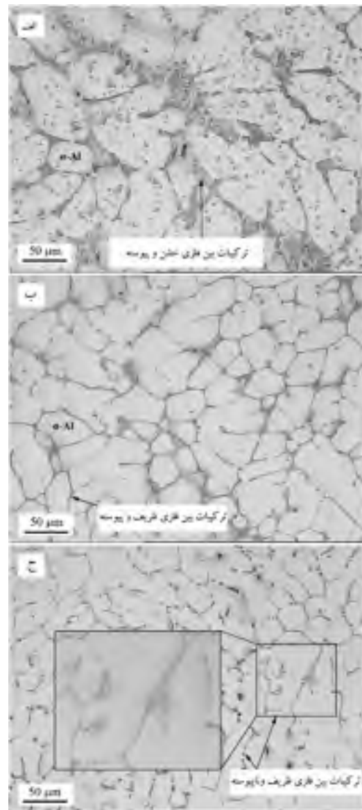
شکل ۶- ریزساختار نوری نمونه های منجمد شده پس از اعمال برش با سرعت ثابت ۸۰۰ دور بر دقیقه در زمانهای (الف) ۰، (ب) ۲ و (ج) ۴ دقیقه. نشان دهنده تاثیر زمان برش مذاب بر شکل شاخه های دندریتی و همچنین مورفولوژی ترکیبات بین دندریتی
