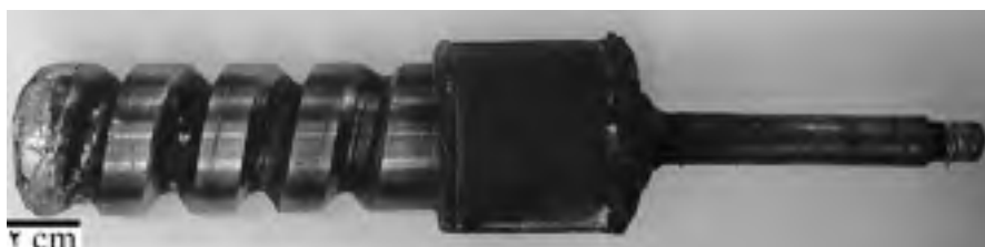
شکل ۱- ماریچ مورد استفاده برای اعمال تنش برشی به مذاب
