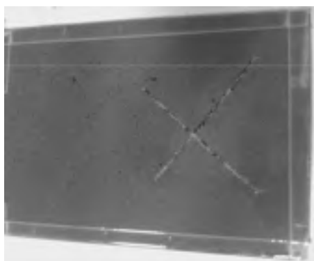
شکل ۱۱- وضعیت فیلم نانوکامپوزیت با ضخامت 75 \pm 5 \mu m بعد از ۱۵۰۰ ساعت در معرض آزمون رطوبت صد در صد اشباع
