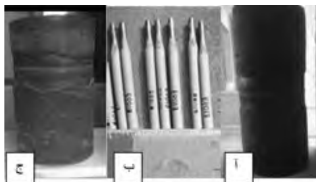
شکل ۲: دو نمونه جوش داده شده به هم (T) و (ج)، الکتروود همه کاره E6۰۱۳ (ب)
