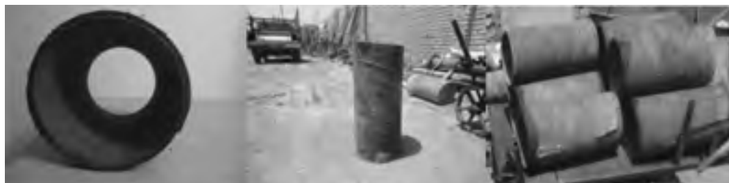
شکل ۱: نمونه لوله های فولادی انتقال گاز دارای پوشش کولتار فرسوده
