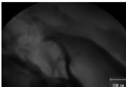
شکل ۷- میکروگراف TEM از نانوکامپوزیت اپوکسی تهیه شده به مدت ۶۰ دقیقه در دمای ۵۰-°C، به روش التراسوند و سخت شده در دمای ۱۱۰°C به مدت ۲۴ ساعت
