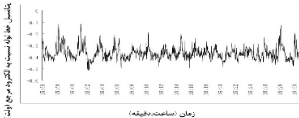
شکل ۲: تغییرات پتانسیل لوله مدفون نسبت به الکترود مرجع \text{Cu}/\text{CuSO}_4 در متروی شانگهای [۸].
