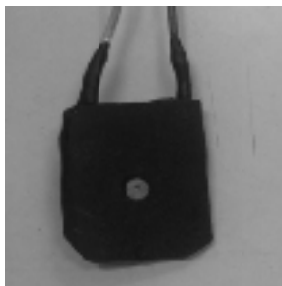
شکل ۴: کوپن خوردگی با پوشش کول‌تار و نقص عمدی یک سانتی متر مربعی.
