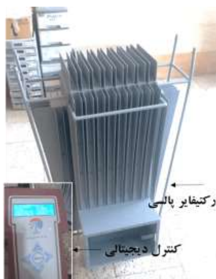
شکل ۱. تصاویر بدنه و کنترل رکتیفایر پالسی.
