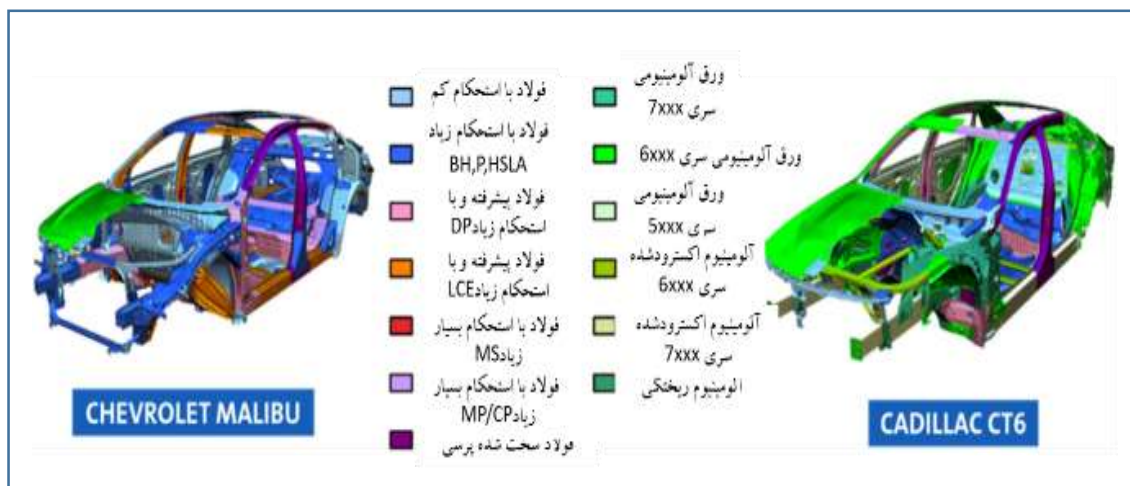
شکل ۱ - قسمت‌های مختلف بدنه دو ماشین کادیلاک و شورلت [۱۲]
