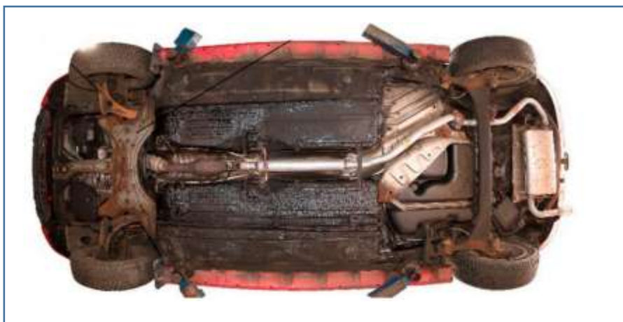
شکل ۲- نمایی از سطح زیرین یک خودرو که دچار خوردگی یکنواخت شده است [۴]
