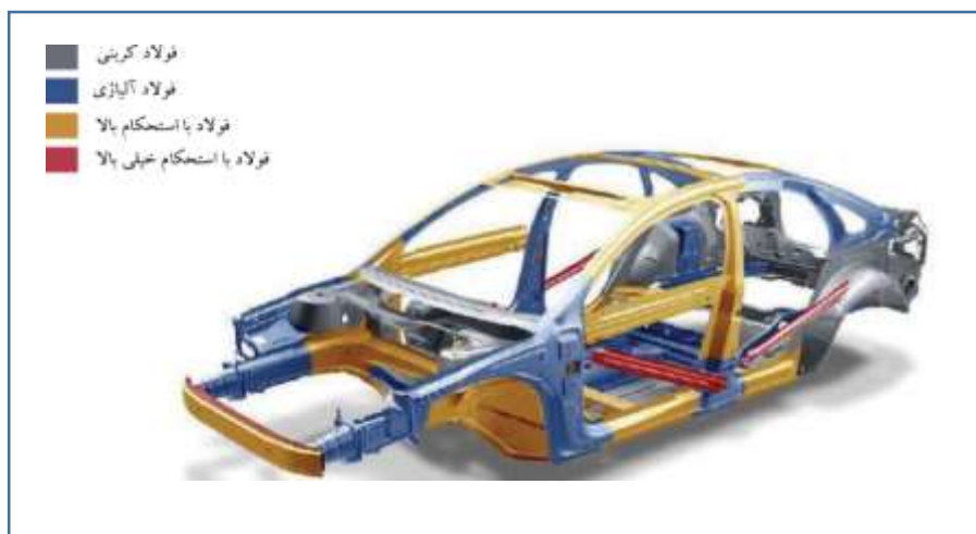
شکل ۳ - توزیع انواع فولادها در بدنه یک ماشین [۳۰]
