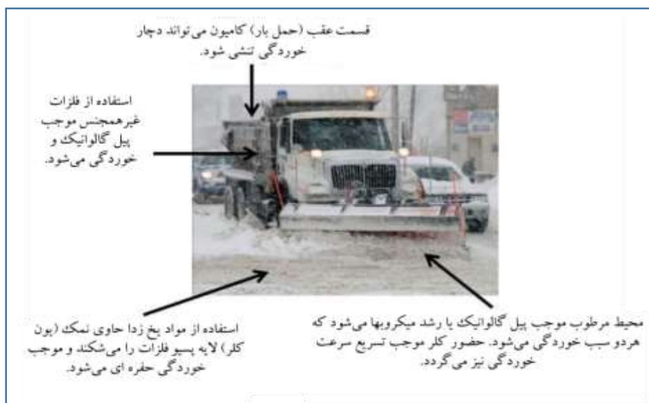
شکل ۵ - انواع خوردگی‌های محتمل در قسمت‌های مختلف یک کامیون برف روب [۳۳]
