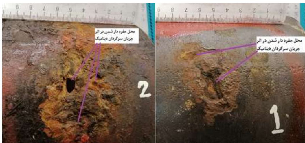
شکل ۲ - تصویر نقطه آسیب دیده لوله در (الف) نقطه اول و (ب) نقطه دوم
