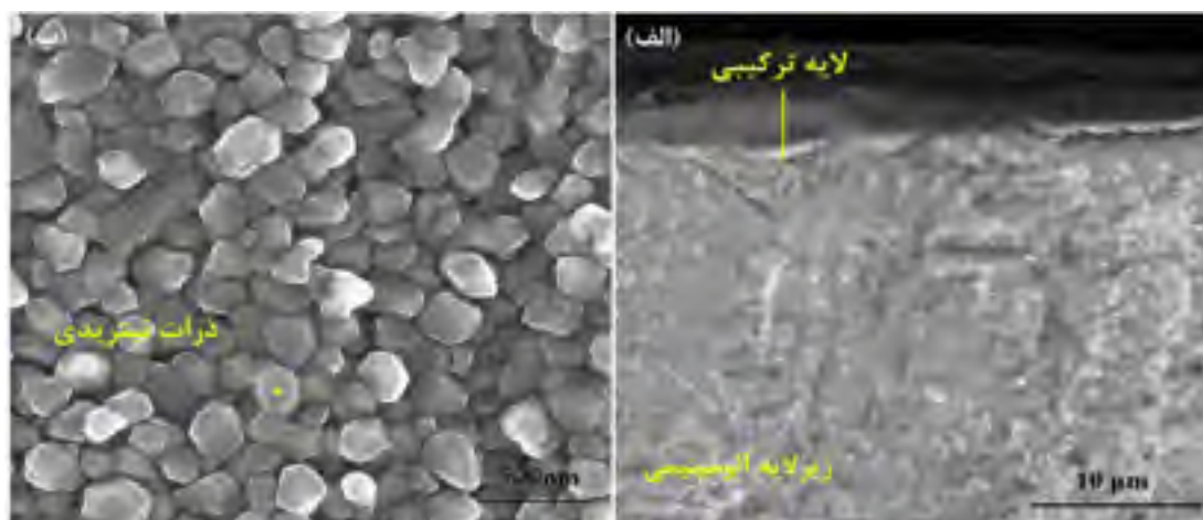
شکل ۳ - تصویر میکروسکوپ الکترونی از نمونه عملیات شده در دمای ۵۰۰°C و زمان ۱۰ ساعت (الف) مقطع عرضی و (ب) سطح نمونه
