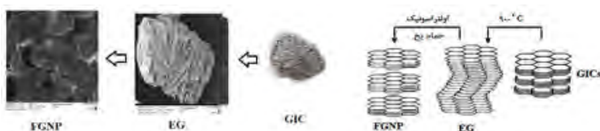
شکل ۱- فرآیند تولید نانوصفحات گرافیت عامل دار از GIC
