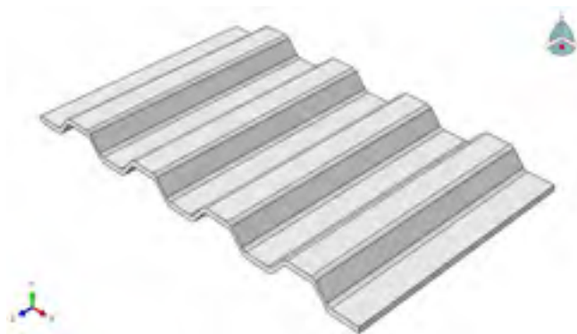
شکل ۱۱ - نمونه طراحی شده برای آنالیز المان محدود ورق مبدل آمین
