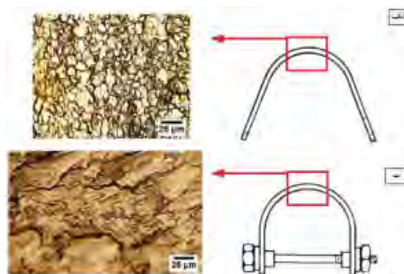
شکل ۱۰ - تصویر میکروسکوپ نوری از سطح نمونه‌های آزمون ترک خوردگی پس از یک ماه غوطه‌وری در محلول آمین رقیق، الف) نمونه‌های بدون پیچ، ب) نمونه‌های پیچ‌دار
