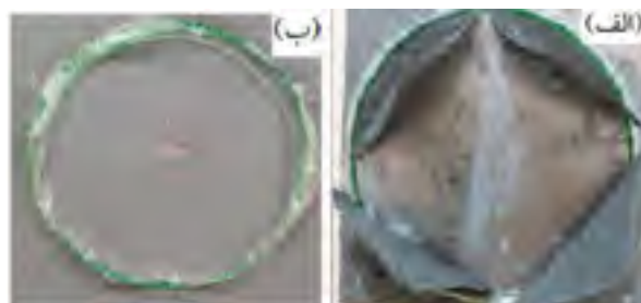
شکل ۷ - سطح پوشش جدا شده از بستر فلز بعد از یک ساعت آزمون جدایش کاتدیک (الف) پوشش شاهد ZRP (ب) نانوپوشش شماره ۸
