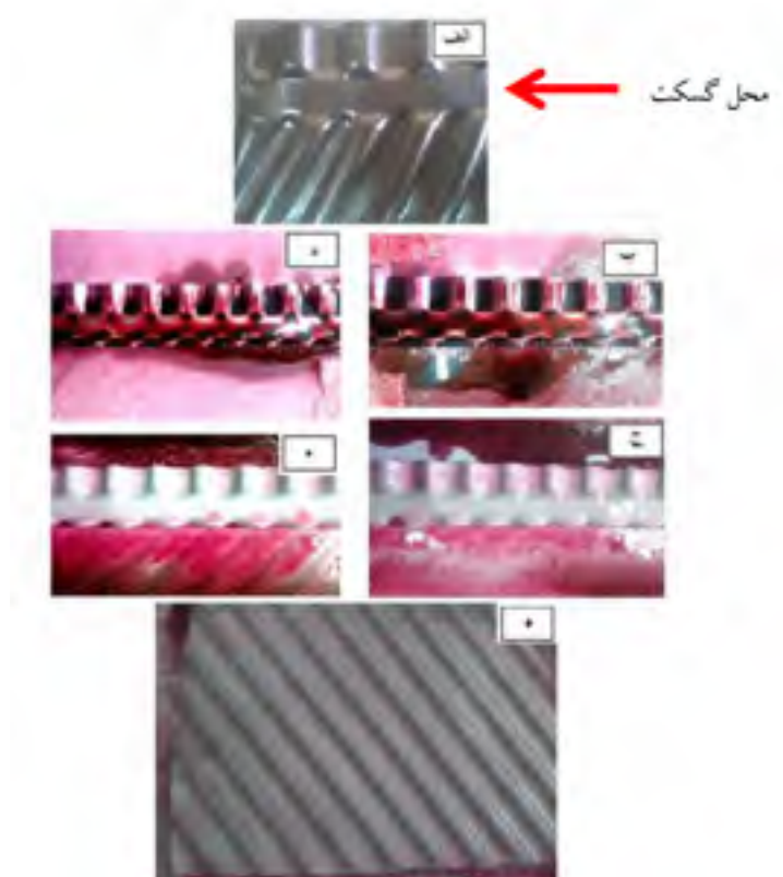
شکل ۴ - تصویر دوربین دیجیتال، الف) نمونه تمیز شده از صفحه مبدل، ب- ه) مایع نافذ و آشکارساز اسپری شده روی محل گسکت و) آشکارساز روی سطح ورق
