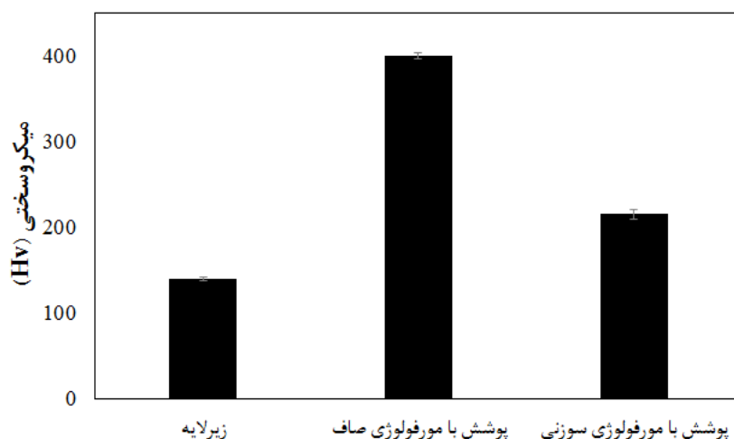
شکل ۴. میکروسختی زیرلایه و پوشش های کبالت با مورفولوژی صاف و سوزنی حاصل از ترسیب در چگالی جریان های ۱۰۰ و \text{mA.cm}^{-2} ۲۰۰.
