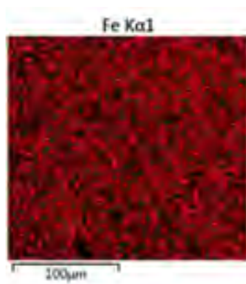
شکل ۷ - الف) تصویر نمونه با پوشش تک جزئی اکسید کروم پس از ۲۸ روز غوطه‌وری در محلول ۳/۵wt% NaCl ب) آنالیز توزیع عنصر آهن در سطح پوشش الف
