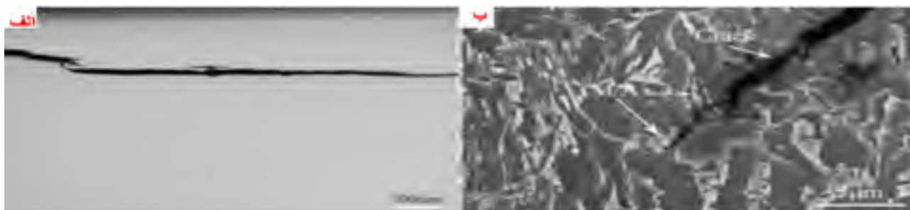
شکل ۱۳ - تصاویر الف) OM و ب) SEM از ترک در فولاد API X80 با میکروساختار LB+GB [۴۸]
