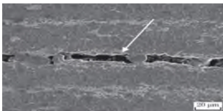
شکل ۱۰ - تصویر SEM از مسیر انتشار ترک با میکروساختار غالب فریت + بینیت [۴۶]
