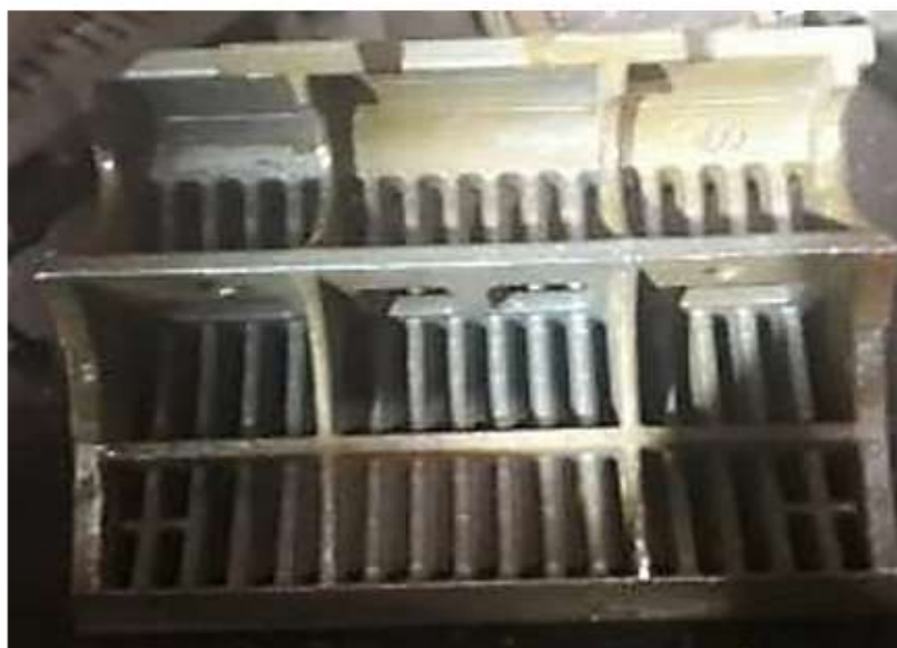
شکل ۱ - صفحه مشبک مورد استفاده جهت قرار گیری در ماشین پخت
