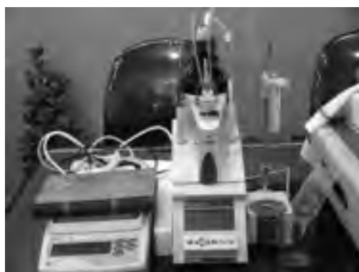
شکل ۳- دستگاه تیتراسیون جهت اندازه گیری مقدار یون کلر
