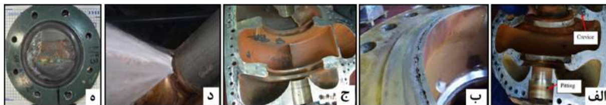
شکل ۳- خوردگی فولاد ضدزنگ گرید دوپلکس ۲۲۰۵ (الف: پمپ و ب) در محل واشر و فلنج؛ خوردگی فولاد ضدزنگ سوپر دوپلکس ASTM A ۸۹۰ (ج: پمپ و د) محل جوش لوله‌ها؛ (ه) خوردگی ماکروسکوپی فکله آب [۵۰].
