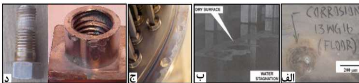
شکل ۱ - الف) تصویر نزدیک از خوردگی در مرکز محفظه پاشش، ب) تصویر بعد از آزمایش پر و خالی کردن آب [۴۶]، ج) خوردگی سطح پایین فلنج بالا، ب) خوردگی در کلاهی شش ضلعی پیچ و مهره [۴۷].
