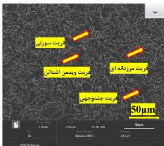
شکل ۱ - تصاویر میکروسکوپی از فولاد API 5L X65 الف- تصویر نوری ب- تصویر الکترونی FESEM
