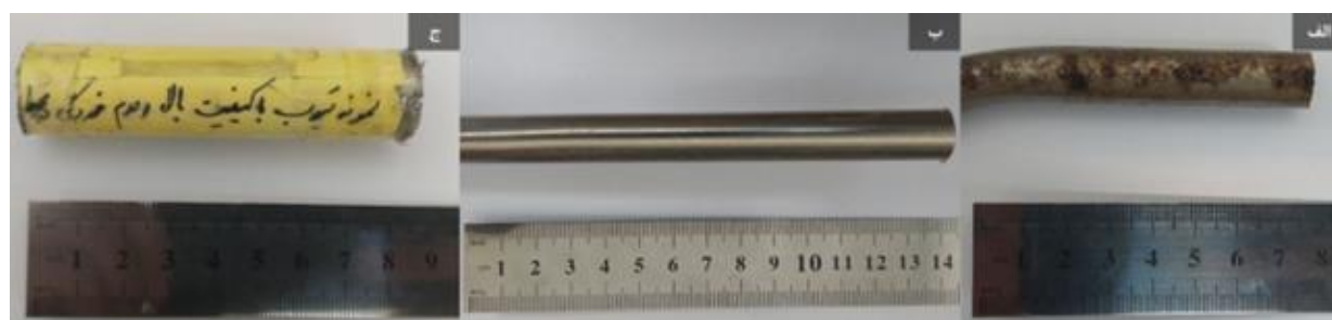
شکل ۱- تصاویر تیوب‌های مورد بررسی: الف) تیوب تخریب شده ب) تیوب کارنکرده ج) تیوب مقاوم به خوردگی
