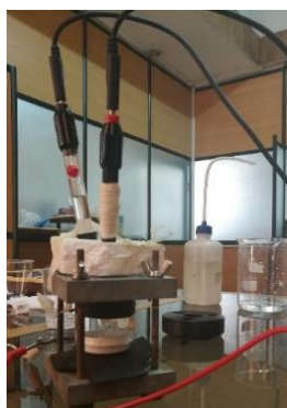
شکل ۲ - پیل ۳ الکترودی Flat cell مورد استفاده در آزمون پلاریزاسیون پتانسیودینامیک و طیف سنج امپدانس الکتروشیمیایی
