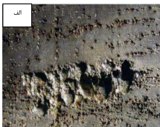
شکل ۳- خوردگی ترش فولاد X۶۵: (الف) خوردگی حفره‌ای و تشکیل خوشه (ب) خوردگی لبه‌ای [۱۹].
