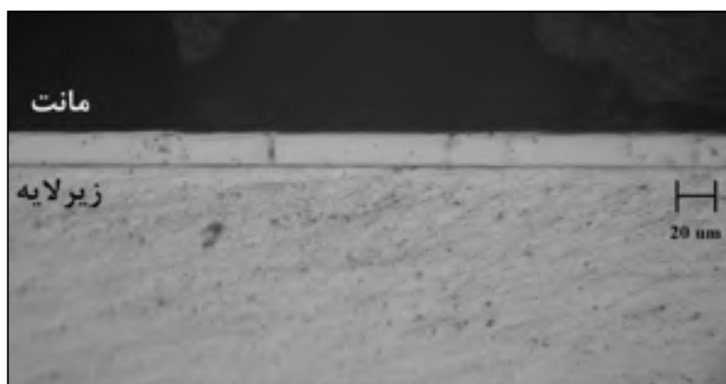
شکل ۵: تصویر میکروسکوپ نوری از سطح مقطع پوشش کروم سه ظرفیتی.
