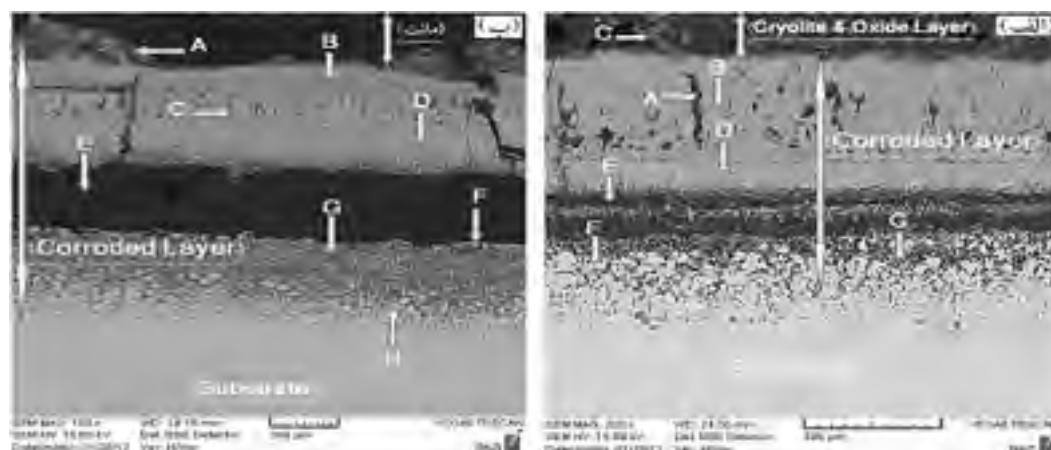
شکل ۴: تصاویر میکروسکوپ الکترونی روبشی از لایه خورده شده نمونه‌های HSLA-100 اکسید شده به مدت ۱ ساعت، پس از انجام: (الف) ۱ و (ب) ۵ ساعت آزمایش خوردگی در محیط کریولیت مذاب در دمای ۹۳۰°C.
